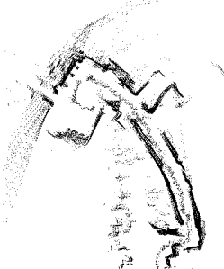
デッドレコニングによる 移動量推定を利用した地図生成
