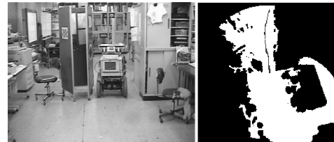
図1 移動中のロボットと生成された地図 地図中の白い部分が移動可能な自由空間でロボットは地図の中心にいる。また自由空間内の曲線は計画された移動経路を示す。
