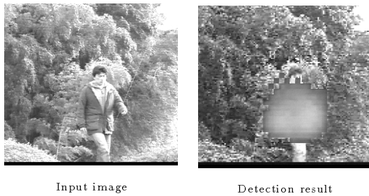
図5 複雑変動背景下での人物の発見 Fig. 5 Person detection in changing background.
