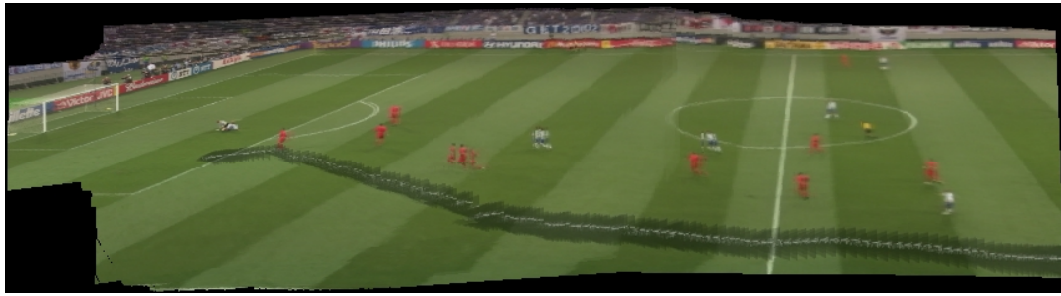
図 3: オンラインで推定したカメラパラメータを用いたモザイク画像の生成
